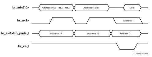
Figure 8-2. Boot ROM Byte Read Cycle
